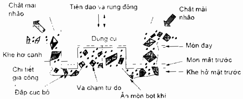
Hình 3.9. Cơ chế bóc tách vật liệu trong gia công bằng siêu âm [19]
